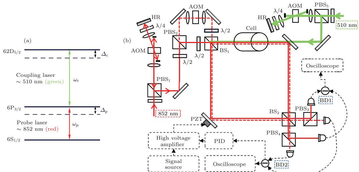
图1 (a) Rydberg EIT 的能级图; (b) 实验装置图
